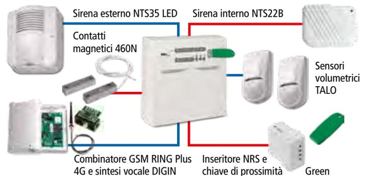
SCHEMA DI COLLEGAMENTO ALLE CENTRALI EG4 Plus - EG8 Plus
